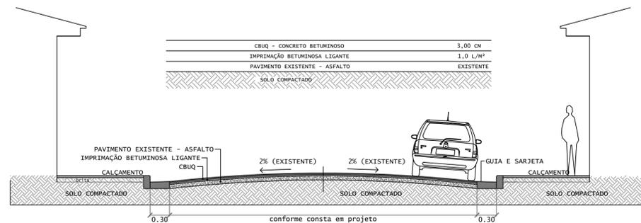
PERFIL - RECAPEAMENTO ASFÁLTICO
