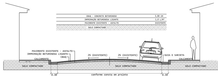
PERFIL - RECAPEAMENTO ASFÁLTICO
